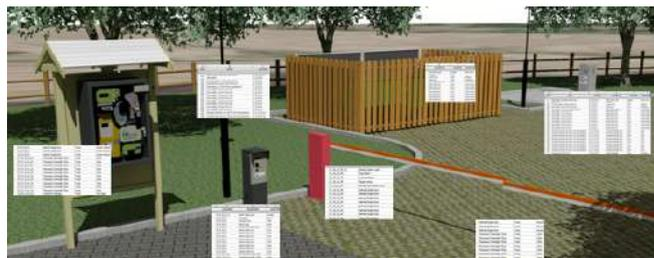
**Figura 3 – Esempio di oggetto intelligente BIM: la colonnina dei servizi di ingresso e uscita**
